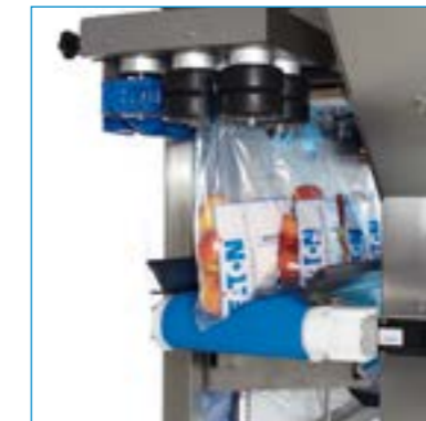
BAG SEPARATOR ABREISSVORRICHTUNG Rubber rollers | Gummirollen
