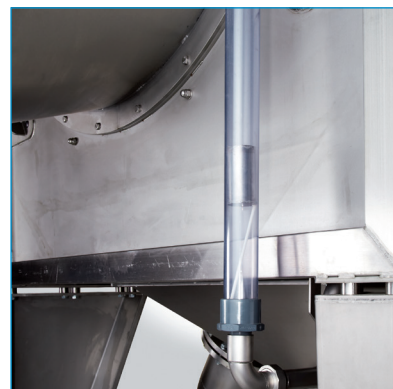
Water level control Füllstandskontrolle
