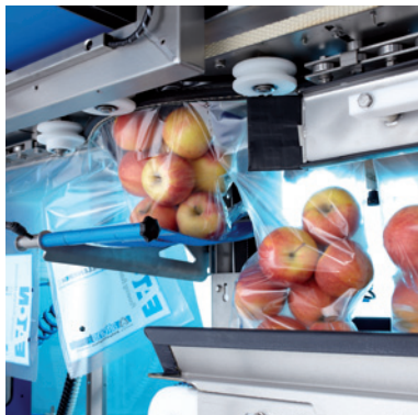
7000 E-A | Horizontal fill and seal machine | New leather coated features for gentle product handling 7000 E-A | Horizontale Füll- und Verschliessmaschine | Neue lederbezogene Bauteile für schonende Produktbehandlung
