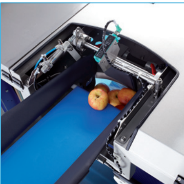
7000 E-A | Horizontal fill and seal machine | New leather coated features for gentle product handling 7000 E-A | Horizontale Füll- und Verschliessmaschine | Neue lederbezogene Bauteile für schonende Produktbehandlung
