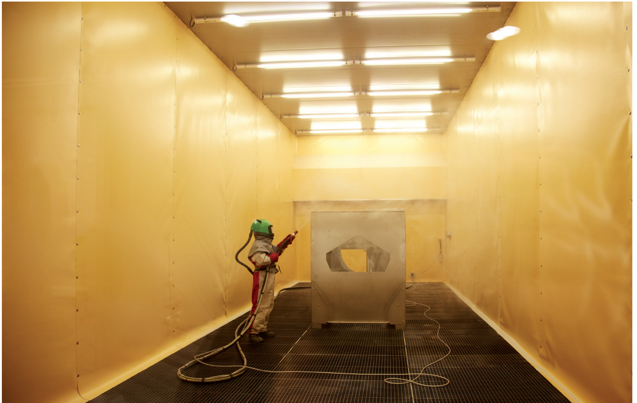
Northern Germany | Bremervörde | 70 m² Glass bead blasting cabinet Norddeutschland | Bremervörde | 70 m² Glasperlenstrahlkabine
