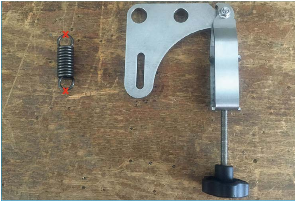
From the left: Old tension spring is replaced by new improved tensioning device Von links: Alte Spannfeder wird ersetzt durch neue verbesserte Spannvorrichtung
