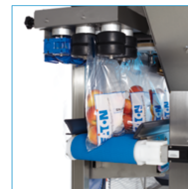
BAG SEPARATOR ABREISSVORRICHTUNG Rubber rollers | Gummirollen
