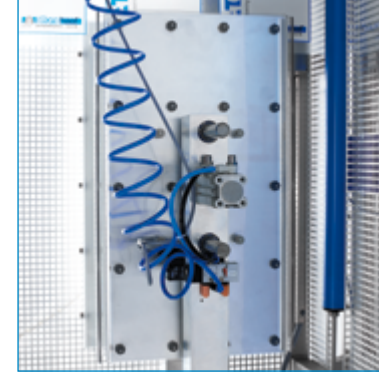
BIG HOLE PUNCH SYSTEM GROSSER STANZGERÄT 20 crowns, Ø 8 mm 20 Kronen, Ø 8 mm Option 7500 E | 7600 E Zubehör 7500 E | 7600 E
