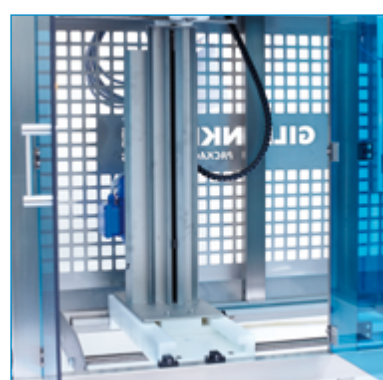
VERTICAL BAG SEPARATOR VERTIKALE EINREISSKETTE For separating premade PE bags Zum Separieren von vorgefertigten PE Beuteln
